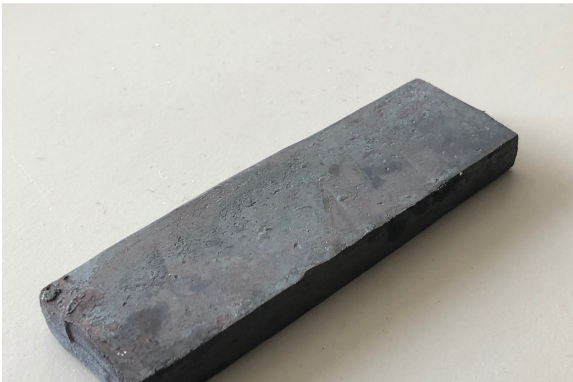
Pakke foldet til 56 lag, dækket af den grå glødeskal.
