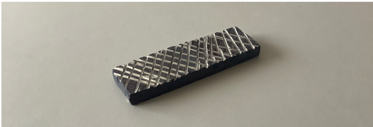
Mønster skåret i pakke med ex. vinkelsliner eller fil
